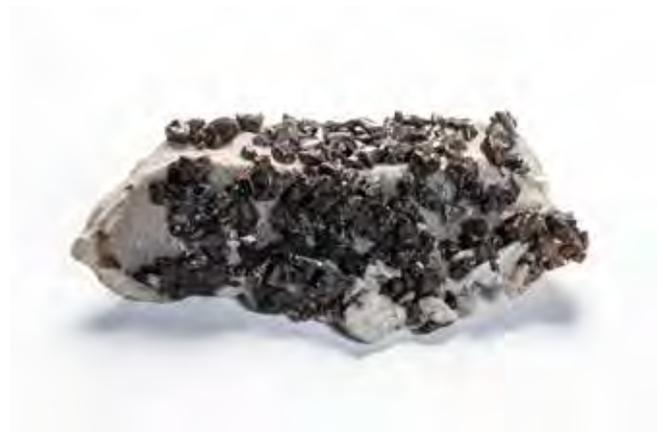
Fig. 2.4.3.10: Zinkblende | Zinc blende (sphalerite)
